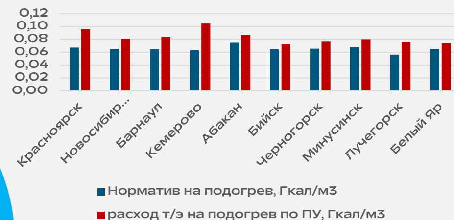
Расход тепловой энергии на подогрев 1 куб м воды для горячего водоснабжения
